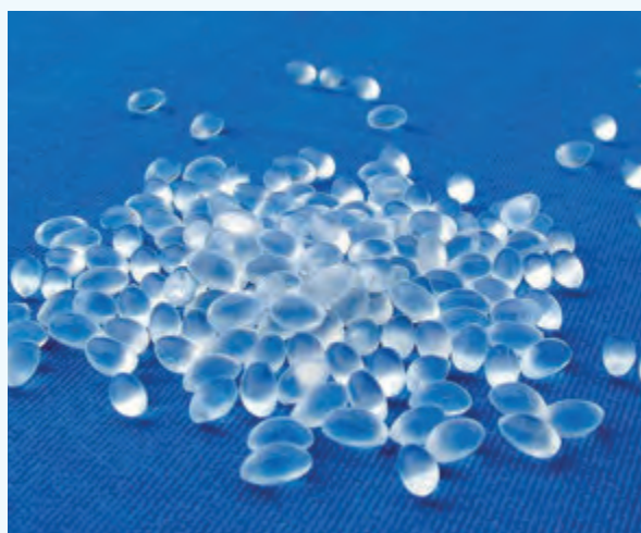
شکل شماتیک گرانول‌های ترموپلاستیک پلی یورتان
